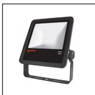
LEDVANCE OSRAM 100W 10.000lm 4.000°k COLORE NERO ANGOLO APERTURA 100° misure 243x93x253 peso 4,2 Kg Alloggiati su flightcase
