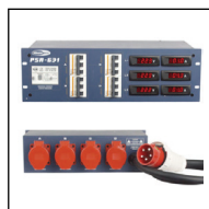
DISTRIBUTORE CON MONITORAGGIO Monitoraggio voltaico e dell'ampere per fase IN: Cavo da 1,5m (5 fili) con presa CEE 3x63A CEE OUT: 4 x prese CEE 3x32A CEE
