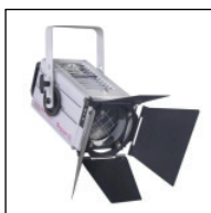
MIDI 150 FRESNEL CDM Zoom variabile Accessorio: Alette paraluce Lampada: CDMSAT150W Mastercolour Alloggiati su flightcase
