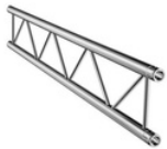
TRALICCIO IN ALLUMINIO PIATTO Sezione piana lato 29cm Lunghezze: 2/1,5 mt
